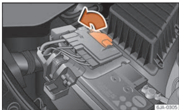
Fig. 247 Bateria: obertura de la coberta.
