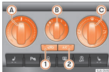
Fig. 168 Aire condicionat: elements de control.
