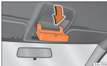
Fig. 155 Un detall del panell del sostre: portaobjectes per a ulleres.
