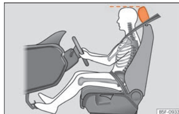
Fig. 72 Posició correcta del reposacaps del conductor.
