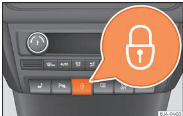
Fig. 3 Consola central: commutador del tancament centralitzat.
