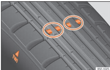
Fig. 249 Perfil dels pneumàtics amb indicadors de desgast.
