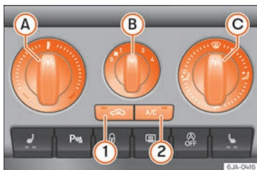
Fig. 46 A la consola central: comandaments de l'aire condicionat manual.
