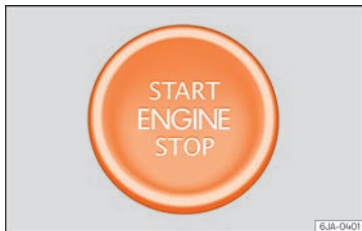
Fig. 211 A la columna de direcció: polsador d'arrencada del sistema de tancament i arrencada sense clau Keyless Access. En els vehicles amb el volant a la dreta, la disposició és simètrica.
