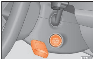
Fig. 212 Arrencada d'emergència en vehicles amb Keyless Access.
