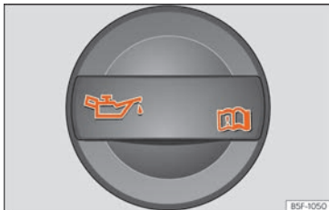
Fig. 50 Tap de la boca d'ompliment d'oli del motor al compartiment del motor.
