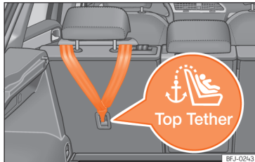
Fig. 1 Part posterior dels seients de la segona fila: argolles de subjecció per al cinturó Top Tether.
