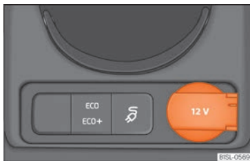
Fig. 105 Consola central davantera: presa de corrent de 12 volts al portaobjectes i interfície USB.
