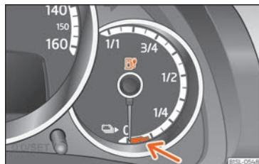
Fig. 148 Al quadre d'instruments: indicador de l'estat de càrrega de la bateria d'alt voltatge amb la zona de la reserva marcada de color vermell (fletxa).
