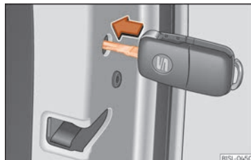
Fig.71 Bloqueig d'emergència del vehicle amb la clau del vehicle.
