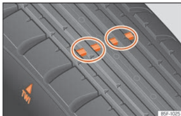
Fig. 169 Perfil del pneumàtic: Indicadors de desgast.
