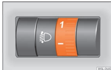
Fig. 82 Al costat del volant: regulador de l'abast dels llums.
