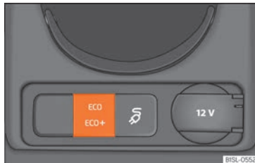
Fig. 138 A la part inferior de la consola central: tecla de selecció del perfil de conducció.
