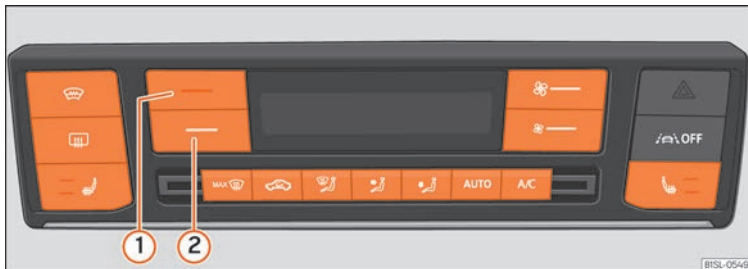
Fig. 108 A la consola central: comandaments del Climatronic.
