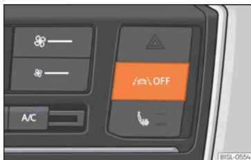
Fig. 141 A la consola central:tecla per connectar el sistema d'avis de sortida de carril
