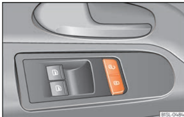
Fig. 69 A la porta del conductor: botons del tancament centralitzat.
