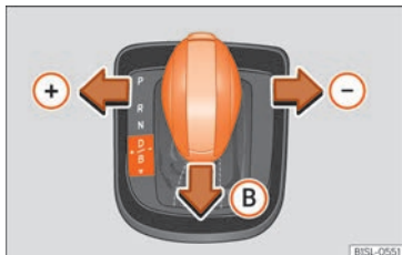
Fig. 134 A la palanca selectora: connectar la recuperació de l'energia de frenada.
