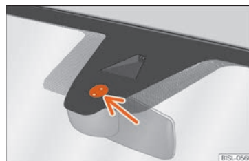
Fig. 86 Superfície sensible del sensor de pluja.
