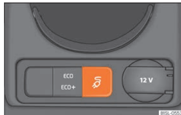
Fig. 155 A la part inferior de la consola central: tecla del mode de càrrega.
