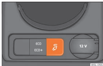
Fig. 152 A la part inferior de la consola central: tecla del mode de càrrega.
