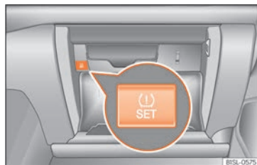
Fig. 171 A la guantera: tecla del sistema de control dels pneumàtics.
