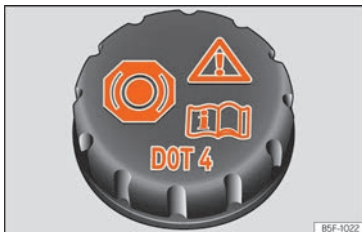
Fig. 165 Compartiment del motor: tap del dipòsit del líquid de frens.
