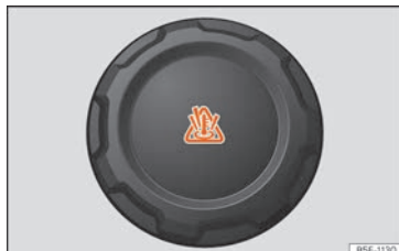
Fig. 164 Compartiment del motor:tap del dipòsit d'expansió del líquid refrigerant.
