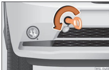
Fig. 43 Part dreta del para-xocs davanter:argolla de remolc enroscada.
