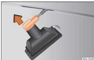
Fig. 55 Llum de la matrícula: desmuntar el portabombetes.
