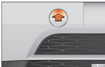
Fig. 42 Part dreta del para-xocs davanter:retirar la tapa.
