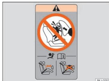
Fig. 22 Adhesiu del coixí de seguretat: en el marc posterior de la porta de l'acompanyant
