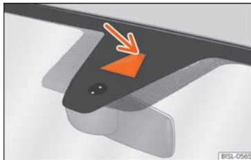
Fig. 140 Al parabrisa: àrea de camp visual del sistema d'avís de sortida del carril.
