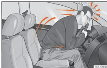
Fig.7 El conductor que no porti el cinturó de seguretat es veurà llançat cap endavant.
