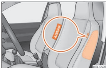
Fig. 17 Coixí de seguretat lateral al seient del conductor.
