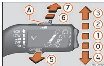
Fig. 84 Maneig de l'eixugaparabrises i eixugavidres posterior.
