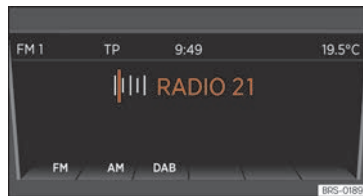
Fig. 110 Menú principal RADIO:seleccionar banda de freqüències.
