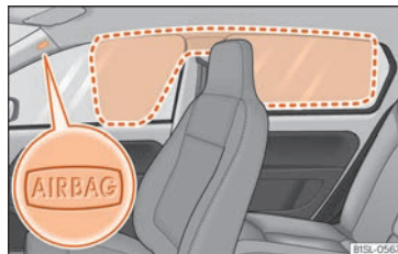
Fig. 19 Ubicació i zona de desplegament del coixí de seguretat per al cap.
