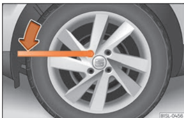
Fig. 33 Canvi de roda: afluixar els caragols de roda.
