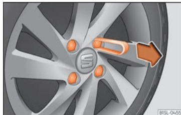
Fig. 31 Roda: caragols de la roda amb caputxons.
