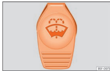
Fig. 45 Al compartiment del motor: tap del dipòsit del netejavidres.
