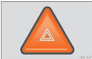
Fig. 32 Tauler d'instruments: commutador dels intermitents d'emergència.
