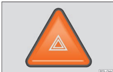
Fig.111 Tauler d'instruments: tecla per encendre i apagar els intermitents d'emergència. »
