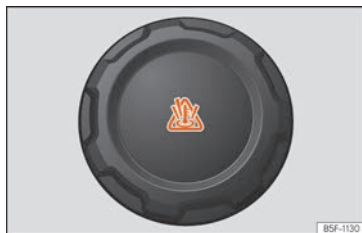
Fig. 184 Al compartiment del motor: Tap del dipòsit d'expansió del líquid refrigerant.
