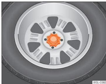
Fig. 190 Al maleter: roda de mà per a la fixació de la roda de recanvi.
