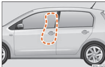
Fig. 23 Al costat esquerre del vehicle: zona de desplegament del coixí de seguretat lateral.
