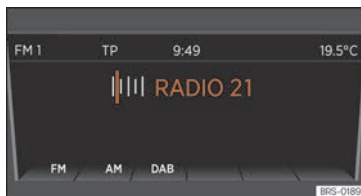
Fig. 145 Menú principal RADIO: seleccionar banda de freqüències.
