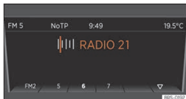
Fig. 148 El canvi d'emissora amb les tecles amb fletxa només és possible cap a les emissores memoritzades.
