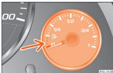
Fig. 177 Al quadre d'instruments: indicador del nivell de combustible per a gasolina.
