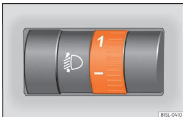
Fig. 112 Al costat del volant: Regulador de l'abast dels llums.
