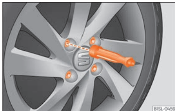
Fig. 58 Canvi de roda: afluixar els caragols de la roda amb el mànec del tornavis.
