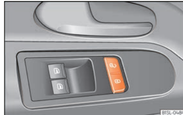
Fig. 104 A la porta del conductor: botó del tancament centralitzat.
