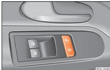
Fig. 3 A la porta del conductor: botó del tancament centralitzat.
