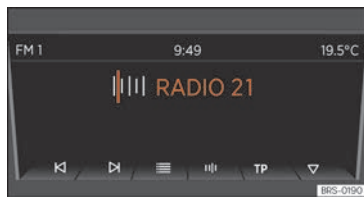
Fig. 151 Indicació en el mode Radio: canvi d'emissora mitjançant les tecles de fletxa.
