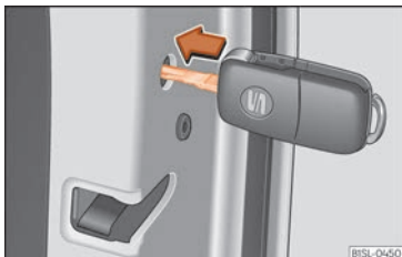
Fig. 6 Bloqueig d'emergència del vehicle amb la clau del vehicle.
