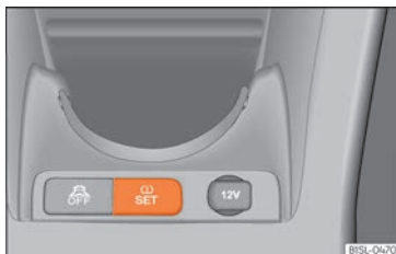
Fig. 189 Consola central: tecla del sistema de control dels pneumàtics
