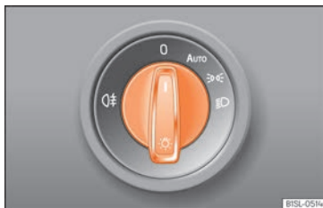
Fig. 110 Al costat del volant: representació d'algunes variants del comandament dels llums.
