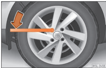
Fig. 54 Canvi de roda: afluixeu els caragols de la roda.
