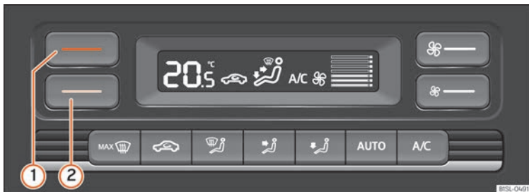
Fig. 142 A la part superior de la consola central: comandaments del Climatronic.
