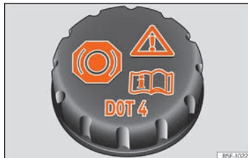
Fig. 44 Compartiment del motor: tap del dipòsit del líquid de frens.
