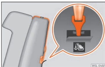
Fig. 28 Exemple d'un cinturó de fixació superior enganxat.
