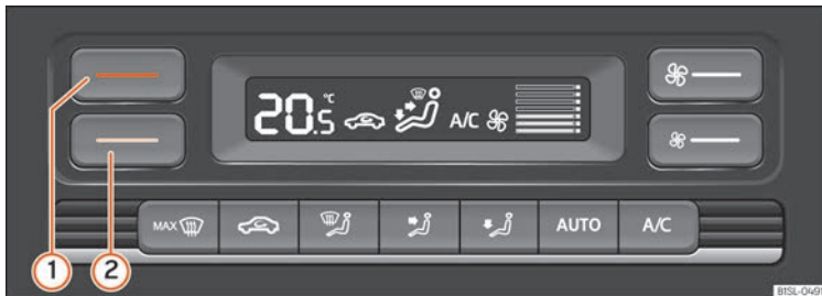
Fig. 38 A la part superior de la consola central: comandaments del Climatronic.
