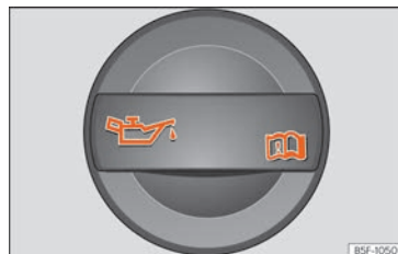
Fig. 182 Al compartiment del motor: tap de la boca d'ompliment de l'oli de motor.
