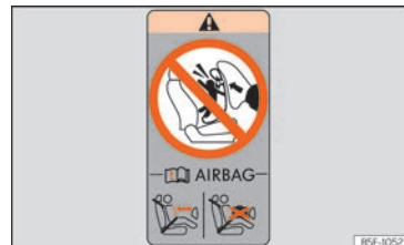
Fig. 25 Al marc posterior de la porta de l'acompanyant: adhesiu relatiu al coixí de seguretat.
