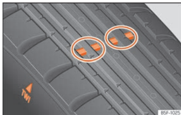
Fig. 188 Perfil del pneumàtic: indicadors de desgast.
