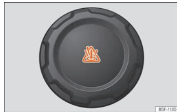
Fig. 43 Compartiment del motor: tap del dipòsit d'expansió del líquid refrigerant.
