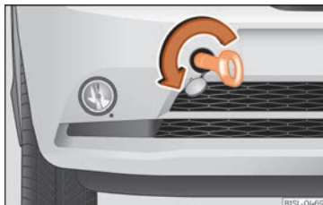
Fig. 59 Part dreta del para-xocs davant: argolla de remolc enroscada.
