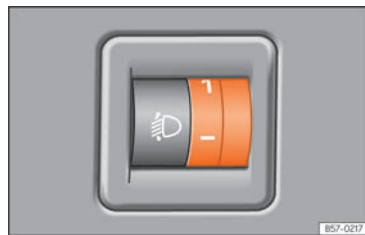
Fig. 72 Al costat del volant: regulador de l'abast dels llums.
