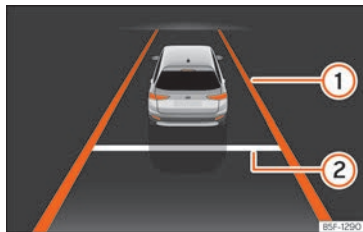
Fig. 114 A la pantalla del quadre d'instruments: visualització amb la regulació activa (representació esquemàtica).
