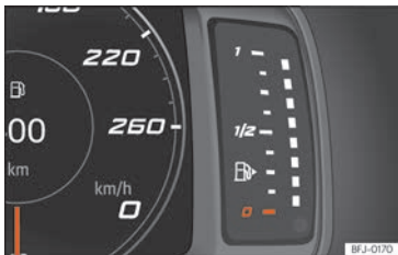
Fig. 6 Quadre d'instruments SEAT Digital Cockpit: indicador del nivell de combustible.
