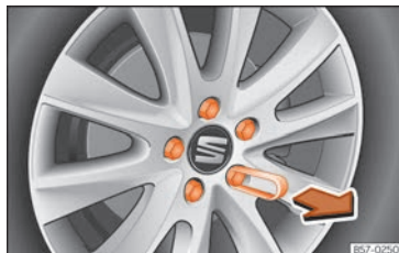
Fig. 195 Roda: caragols de la roda amb caputxons.
