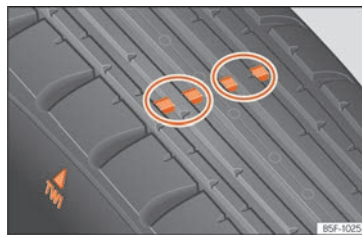
Fig. 191 Perfil del pneumàtic: indicadors de desgast.
