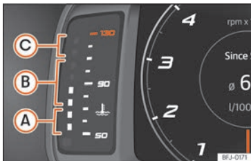
Fig. 8 Quadre d'instruments digital SEAT Digital Cockpit: indicador de temperatura del líquid refrigerant del motor.
