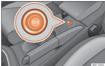
Fig. 136 Presa de corrent de 12 volts del vehicle.
