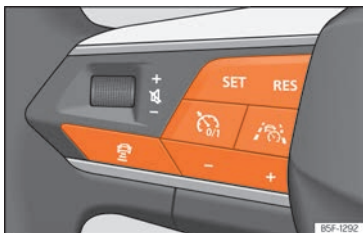
Fig. 115 Costat esquerre del volant multifunció.
