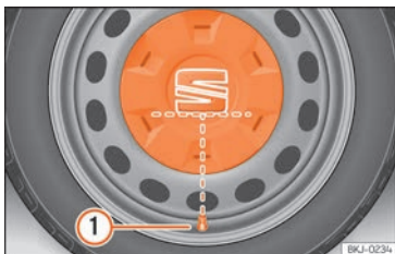
Fig. 194 Col·locació correcta de l'embellidor central de roda per a llandes d'acer.
