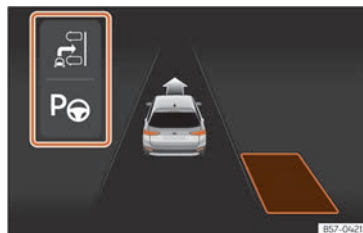
Fig. 126 A la pantalla del quadre d'instruments: visualització del sistema d'aparcament assistit amb visualització reduïda.
