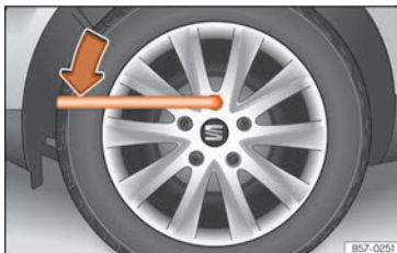
Fig. 197 Canvi de roda: afluixar els caragols de roda.
