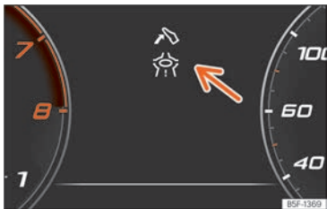
Fig. 102 Indicació de l'assistència per a una conducció ecoeficient (representació esquemàtica).
