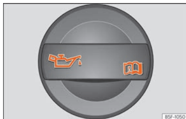
Fig. 188 Tapa de la boca d'ompliment d'oli del motor al compartiment del motor.
