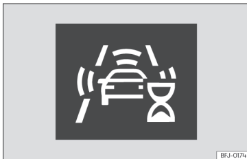
Fig. 111 A la pantalla del quadre d'instruments: indicació d'autocalibratge inicial del sistema.
