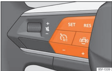
Fig. 101 Al volant multifunció: botons per controlar el limitador de velocitat.
