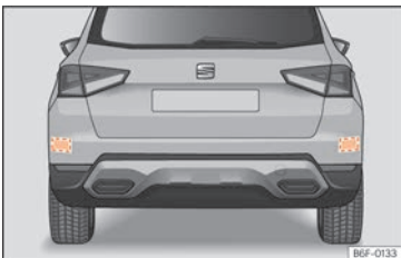
Fig. 97 Vista posterior del vehicle: zones dels sensors de radar.
