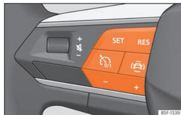
Fig. 100 Al volant multifunció: botons per controlar el regulador de velocitat.
