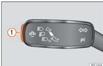
Fig. 92 A la palanca d'intermitents i de llum de carretera: tecla per als sistemes d'assistència al conductor (segons versions).
