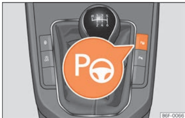
Fig. 125 A la consola central: tecla per connectar el sistema d'aparcament assistit.
