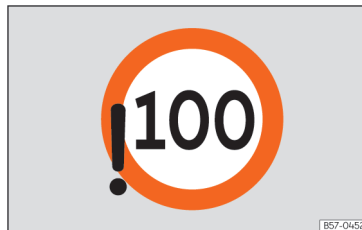
Fig. 11 A la pantalla del quadre d'instruments: detectada infracció de la velocitat màxima permesa (il·lustració).
