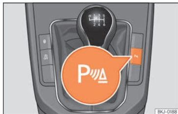
Fig. 122 Consola central: tecla de l'ajuda d'aparcament (segons versions).
