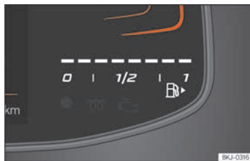
Fig. 5 Quadre d'instruments digital: indicador del nivell de combustible.
