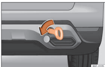
Fig. 168 A la part dreta del para-xocs del darrere: argolla de remolc enroscada.
