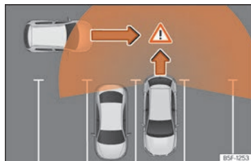
Fig. 132 Representació esquemàtica de l'assistent de sortida de l'aparcament: zona vigilada al voltant del vehicle que està sortint de l'aparcament.
