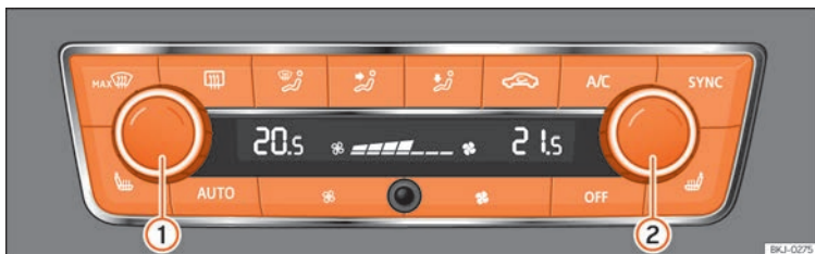
Fig. 80 A la consola central: comandaments del Climatronic.
