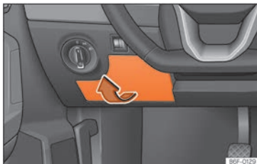
Fig. 169 Al tauler d'instruments del costat del conductor (volant a l'esquerra): tapa de la capsa de fusibles.
