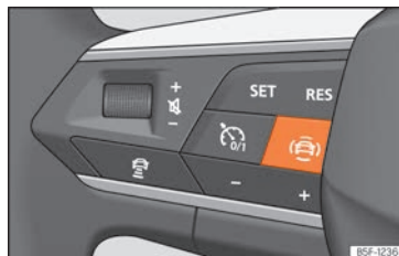
Fig. 93 Costat esquerre del volant multifunció: tecla per als sistemes d'assistència al conductor (segons versions).
