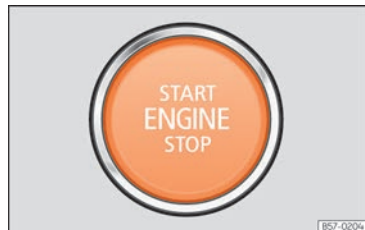
Fig. 83 A la part inferior de la consola central: pulsador d'arrencada.
