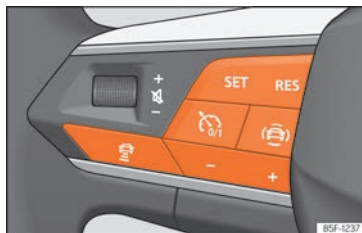
Fig. 104 Al volant multifunció: botons per fer servir l'ACC.
