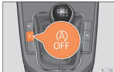
Fig. 85 Consola central: tecla del sistema Start-Stop.
