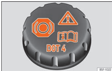
Fig. 183 Compartiment del motor: tap del dipòsit del líquid de frens.
