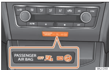
Fig. 30 Tauler d'instruments: indicador de coixí de seguretat de l'acompanyant desactivat.
