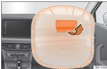
Fig. 28 Coixí de seguretat de l'acompanyant en el tauler d'instruments.
