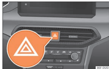
Fig. 43 Tauler d'instruments: commutador dels intermitents d'emergència.
