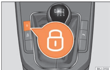
Fig. 52 Consola central: botó del tancament centralitzat.
