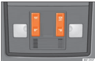
Fig. 73 Detall del revestiment del sostre: il·luminació davantera de l'habitacle.
