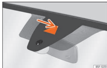
Fig. 96 Al parabrisa: àrea de camp visual del sistema d'avis de sortida del carril.
