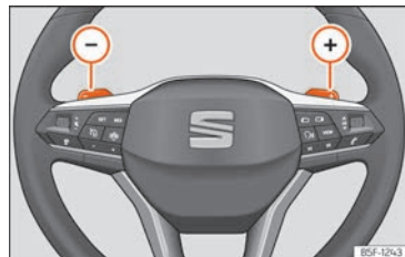
Fig. 89 Volant: palanques per a canvi automàtic.
