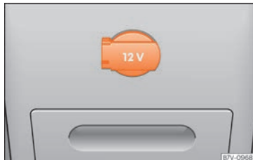
Fig. 171 Part posterior de la consola central: presa de corrent de 12 volts.
