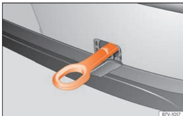
Fig. 57 A la part dreta del para-xocs del darrere: argolla de remolc enroscada.
