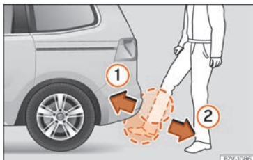
Fig. 106 Porta del maleter amb obertura controlada per sensor (Easy Open).
