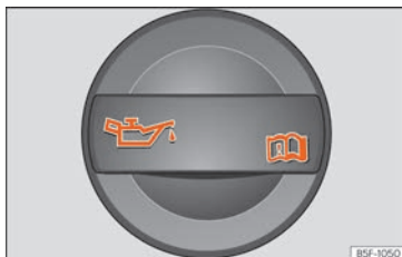
Fig. 288 Tap de la boca d'ompliment d'oli del motor al compartiment del motor.
