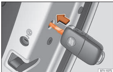
Fig. 97 Bloqueig d'emergència del vehicle amb la clau del vehicle.
