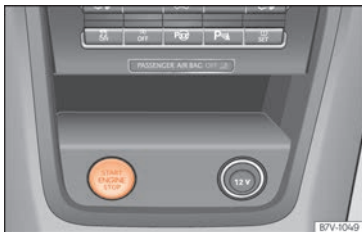
Fig. 231 A la consola central: pulsador d'arrencada del sistema de tancament i arrencada sense clau Keyless Access. En els vehicles amb el volant a la dreta, la disposició és simètrica.
