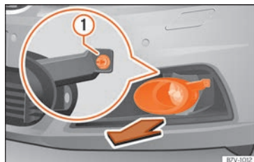
Fig. 66 A la part dreta del para-xocs davant: desmuntatge dels fars.
