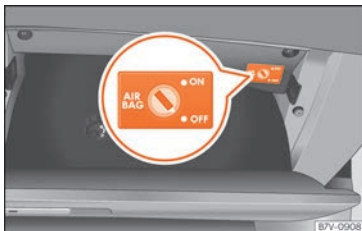
Fig. 18 A la guantera, al costat de l'acompanyant: Interruptor de clau per activar i desactivar el coixí de seguretat frontal de l'acompanyant.
