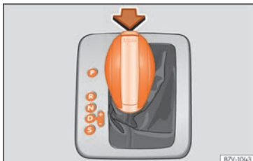
Fig. 235 Palanca selectora del canvi automàtic amb tecla de bloqueig (fletxa).
