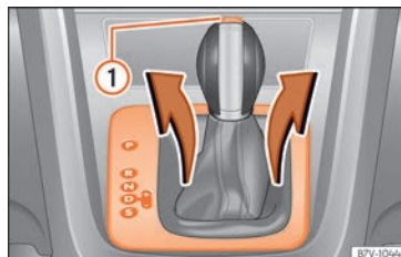
Fig. 238 Desmuntar el revestiment del camp d'indicació de les marxes.
