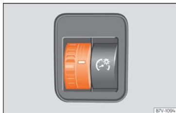
Fig. 119 Al costat del volant: regulador de la il·luminació dels instruments i els comandaments
