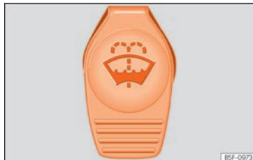
Fig. 292 Al compartiment del motor: tap de color blau del dipòsit de l'eixugavidres.
