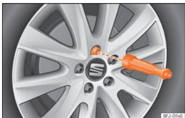
Fig. 49 Canvi de roda: desenroscar els caragols de roda amb el mànec del tornavís.
