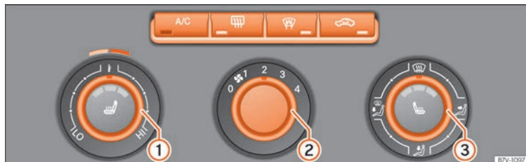
Fig. 174 A la consola central: comandaments de l'aire condicionat manual.
