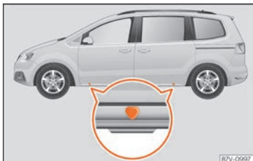
Fig. 47 Punts de suport del gat.
