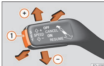
Fig. 248 A l'esquerra de la columna de la direcció: tercera palanca per a manejar el GRA.
