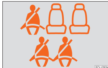
Fig. 6 Exemple d'indicació de l'estat del cinturó a les places del darrere (aquí, en un vehicle de 7 places) al quadre d'instruments: a dalt, la segona fila; a baix, la tercera fila de seients.
