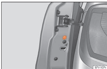
Fig. 96 A la part frontal de la porta corredissa: bloqueig d'emergència, ocult per una junta de goma.
