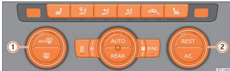
Fig. 173 A la consola central: comandaments del Climatronic.
